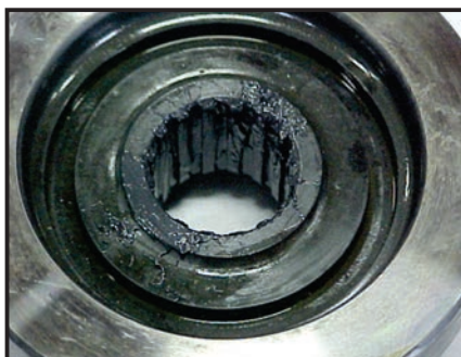
Entalhado do cone do freio do Trole
